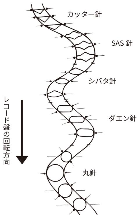
レコードの音溝とチップ針の形状が相違しているほど、振幅の大きい再生でも歪みは生じません。
